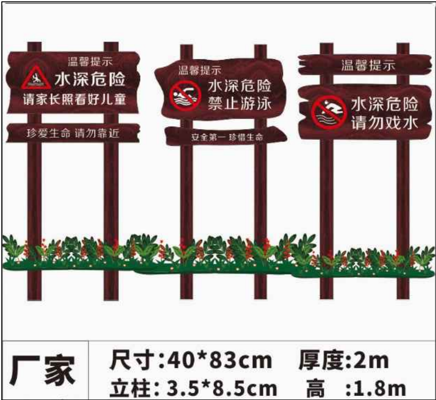
防腐木警示牌示意图 注：共安装32块
